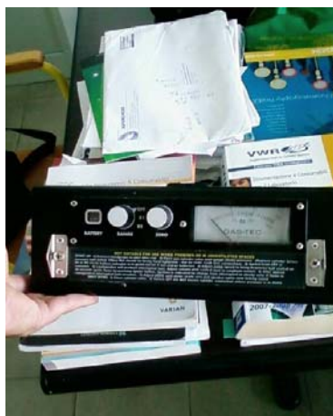
Foto 1: Modulo di indagine a fiamma ionizzante (F.I.D.)
