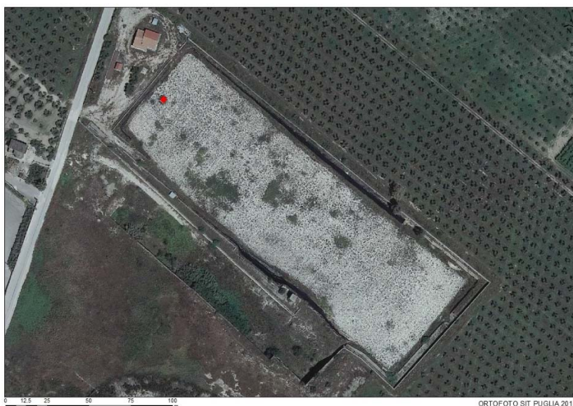
Figura 4: Planimetria discarica ed ubicazione del pozzo di estrazione del percolato (in rosso)
